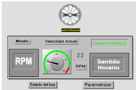
Fig.6 Pantalla gráfica de monitorización en el SCADA
