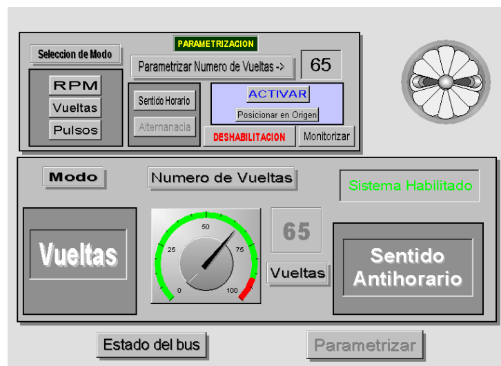
Fig.7. Pantalla gráfica de parametrización en el SCADA
