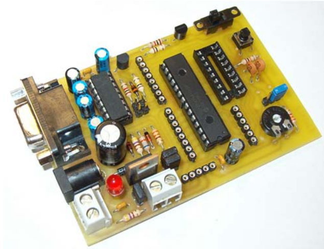
Figura 3. Kit del PIC confeccionado por un alumno de la asignatura.
