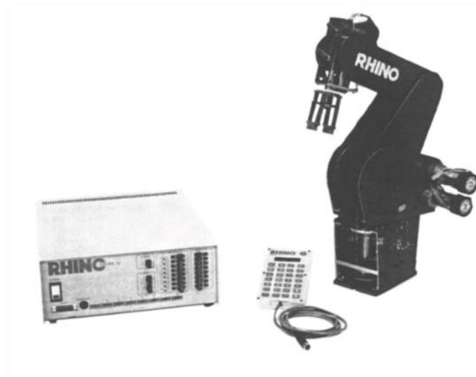
Figura 1: Sistema robótico Rhino compuesto por controlador Mark IV, brazo XR-4 y paleta de programación
